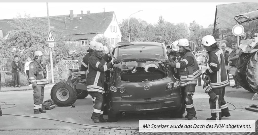
Mit Spreizer wurde das Dach des PKW abgetrennt.
