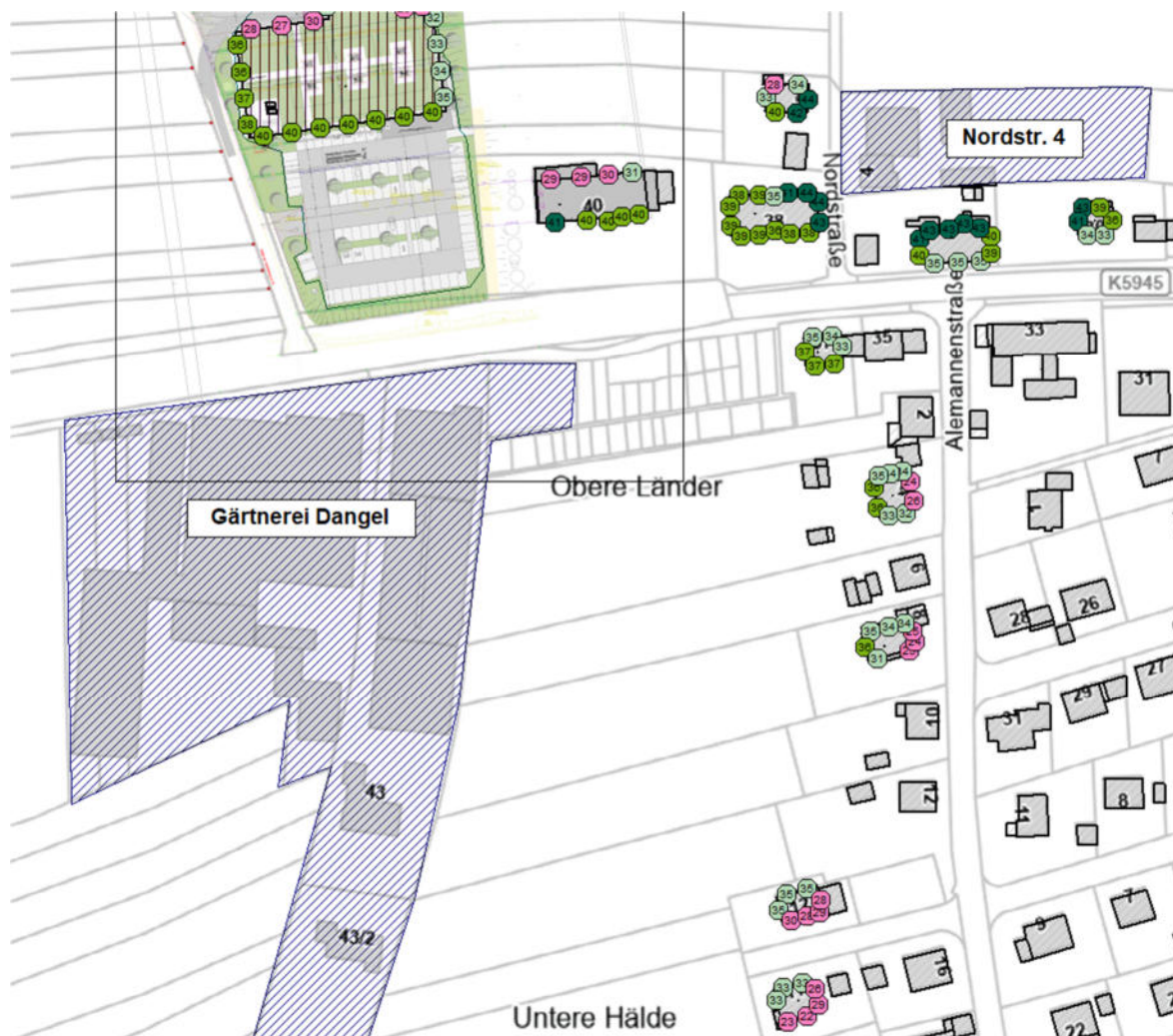
Bild 3: Ausschnitt aus dem digitalen Geländemodell, Darstellung der Beurteilungspegel der schalltechnischen Vorbelastung im Nachtzeitraum.
